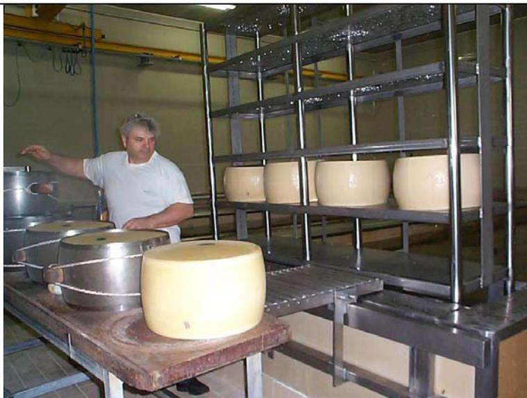
Laddove sia praticato il trasferimento delle forme dai cestelli del salatoio ad immersione ad un altro cestello che poi andrà in camera calda (ciò può essere necessario per mantenere pulita la salamoia) è possibile dover effettuare manovre altamente pericolose come quella di prelevare o collocare una forma troppo in basso o troppo in alto (la figura in basso mostra un cestello da camera calda a 3 ripiani utili).
